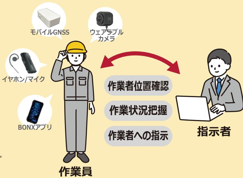
※1: 全地球測位衛星システム(GNSS)から取得した位置情報をベースに、地上に敷設された基準局からの補正情報を加えることで位置情報の精度を上げる技術になります。
